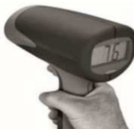
Figure 2. Radar portatif utilisé lors de la mesure de la vitesse (indiquée en \text{km.h}^{-1} ).
